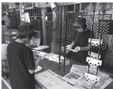
亜鉛めっき処理ライン (ガイドパイプをめっき処理する現場)
