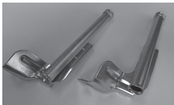
大橋鉄工様から受注した ガイドパイプの亜鉛めっき処理
