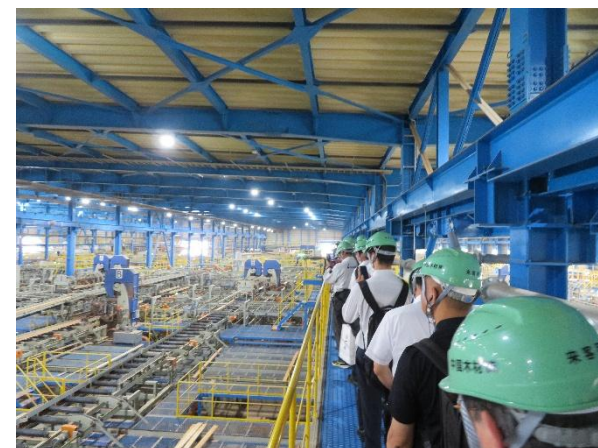
作業はほぼ機械で行われており、2交代制で稼働している（写真：製材棟）
